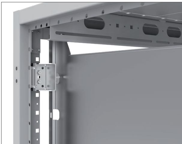
Płyta montażowa mocowana za pomocą uchwytu pojedynczego do ceownika, przesunięta maksymalnie do tyłu szafy
