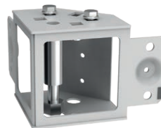
Narożnik cokołu wyposażony w śrubę poziomującą do szafy SZB IT lub DSR IT
