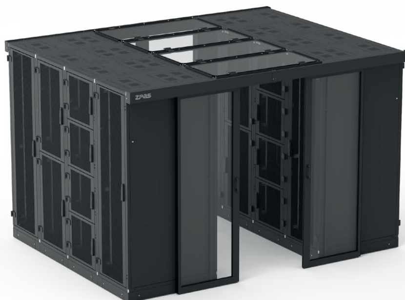
Przykładowa zabudowa Data Box składająca się z: 4 szaf SZB IT 42 U, 800 x 1000 mm, 2 szaf DSR IT 42 U, 800 x 1000 mm o 2 przedziałach, 2 szaf DSR IT 42 U, 800 x 1000 mm o 4 przedziałach, drzwi przesuwnych, płaskiego dachu korytarza. Szafy stoją na cokole o wysokości 100 mm.
