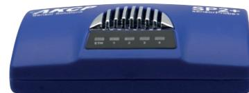
Überwachungssystem, ausgestattet mit 4 RJ-45-Buchsen und einer Ethernet-Buchse, optional auch mit einem GSM-Modul. Unterstützung für 4 intelligente Sensoren oder bis zu 20 potentialfreie Eingänge. Bietet die Möglichkeit, Erweiterungsmodule anzuschließen.
