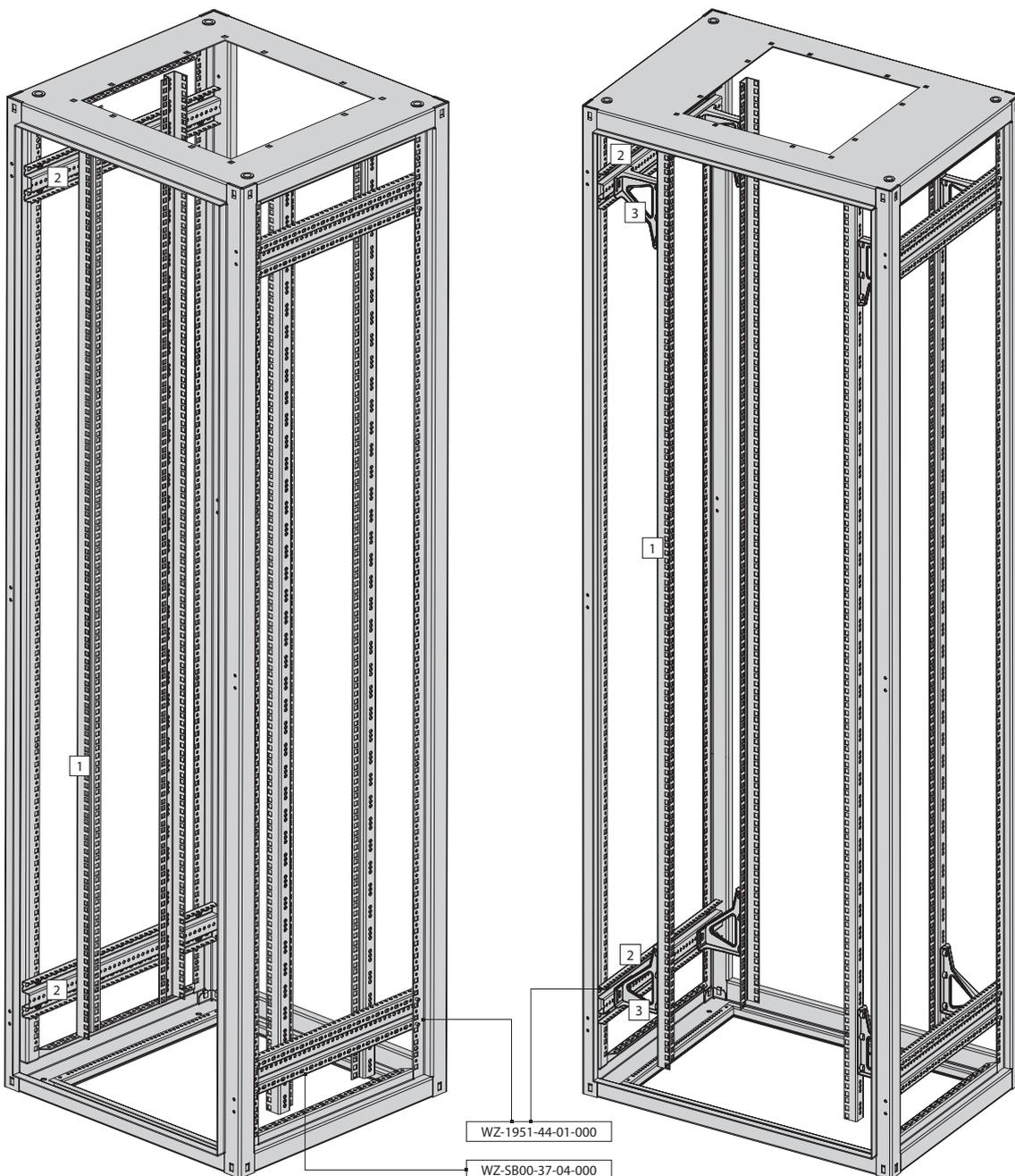
**Eingesetzte Befestigungselemente:** WZ-1951-44-01-000 - selbstformende Schrauben M6x16 (S. 43)
