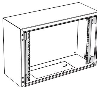
SWN-Gehäusekorpus mit eingebautem Gestell aus 19"-Tragwinkeln
