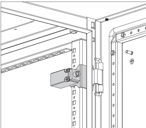
Montage des Türpositionsschalters
