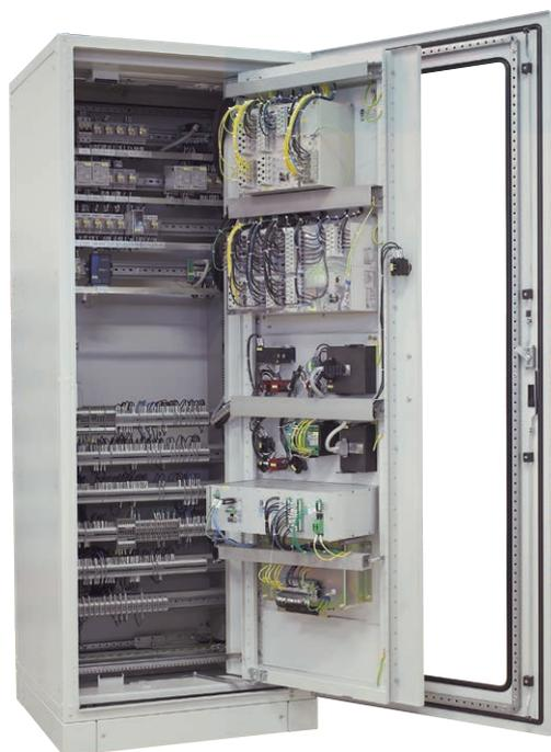
В шкафу защиты предусматривается установка релейного защитного оборудования, управляющей и сигнализационной аппаратуры, контрольно-измерительных приборов. Оборудование монтируется на поворотной симметричной раме, монтажной панели или на монтажном каркасе, собранном из профилей и реек внутри шкафа. Конструкция шкафа возможна как с односторонним, так и с двусторонним доступом к оборудованию (спереди и сзади).
